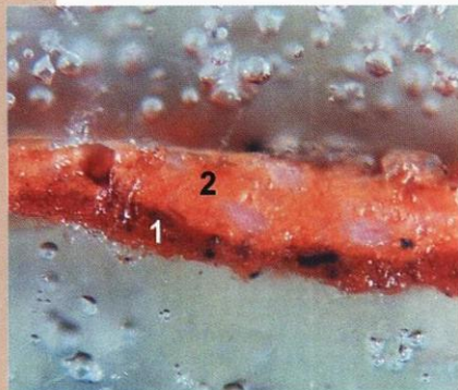
Zdjęcie mikroskopowe w świetle białym przekroju próbki pobranej z obrazu „Zmartwychwstanie” (czerwona szarfa Chrystusa): 1 – ciemnoczerwona warstwa zaprawy (spoiwo: białko i olej, pigmenty: czerwień żelazowa i czerń roślinna), 2 – czerwona warstwa malarska (spoiwo: białko i olej, pigmenty: minia i biel ołowiana). Fot. Damian Lizun.
